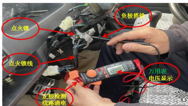
图2:点火信号线、钥匙开关常电线查找：
