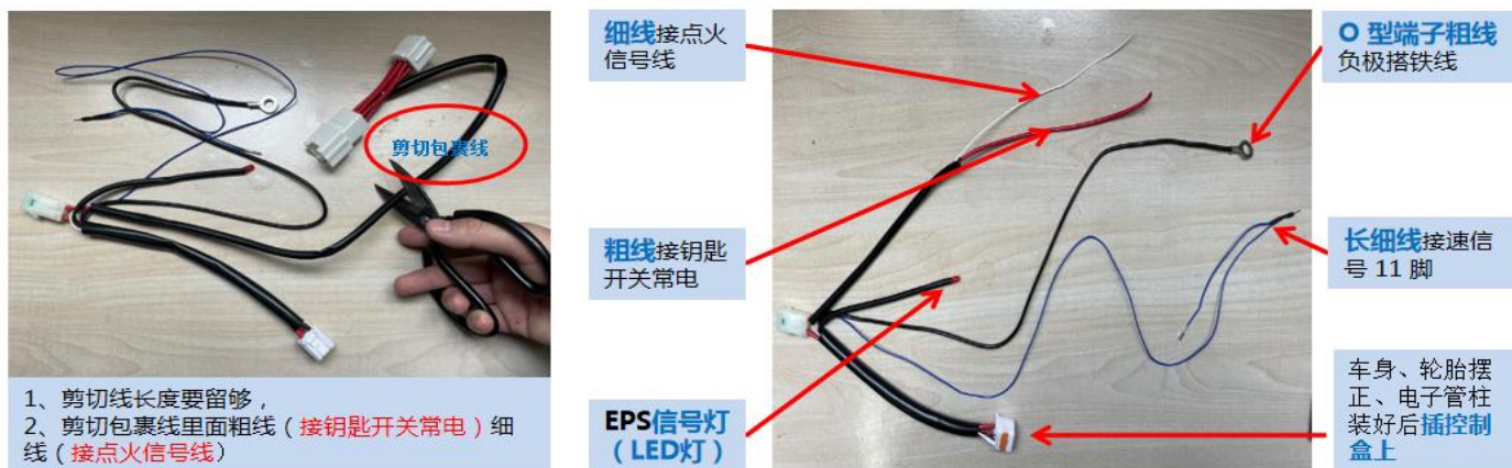
图1:自接线束或改接线束示意图
